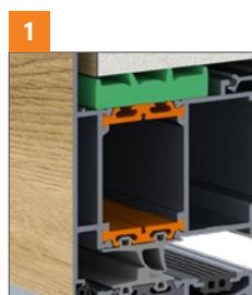
TŘÍKOMOROVÉ PROFILY S HLOUBKOU 77 MM TEPELNÝMI DISTANČNÍMI VLOŽKAMI
